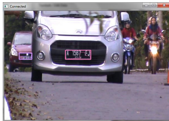
Gambar 9 lokasi plat kendaraan yang sudah dideteksi
