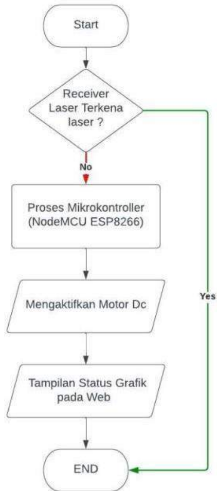
Gambar 8. Flowchart Sistem Otomatisasi Pengusir Hama Burung
