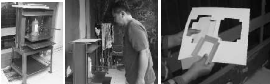
Gambar 2: Peralatan Plong Kertas/Karton Tenaga Dongkrak
