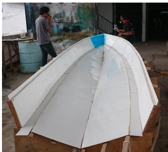
Gambar 3.6 Pesangan dinding cetakan kapal
