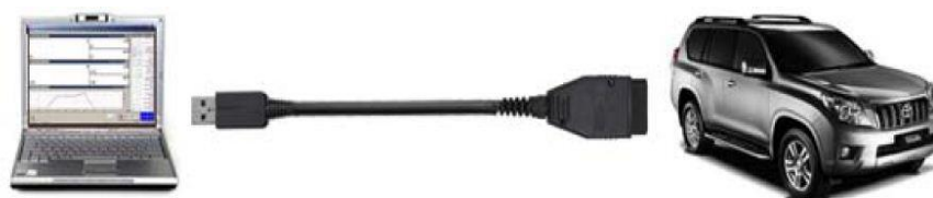
Gambar 2.5 Skema pemasangan kabel data ECU ke Komputer
