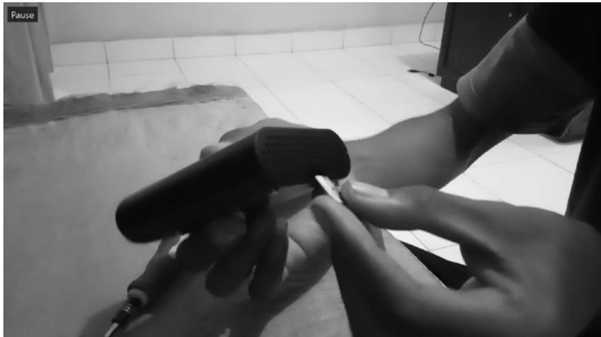
Gambar 4. Pemasangan *SD Card* pada Raspberry Pi 3
