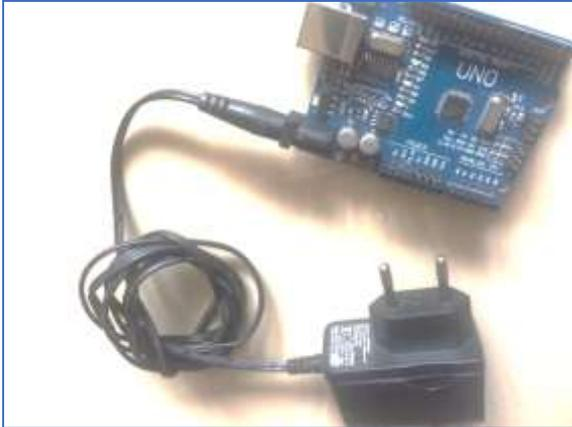
Gambar 8. Rangkaian adaptor dengan arduino
